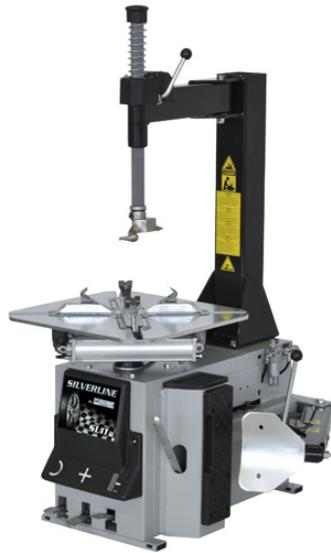
Démonte-pneu semi-automatique avec bras pivotant, blocage de roue 10"-24", équipé de huileur levier décolle-talons et régulateur de pression à 3,5 Bar (50 Psi), vérin décolleur à double effet d.200mm., outil de montage professionnel protégé contre le contact avec la jante.
